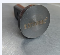
Bild 4: Abstandshalter eindrücken – Stößelmaß 25 mm stellt sich automatisch ein
