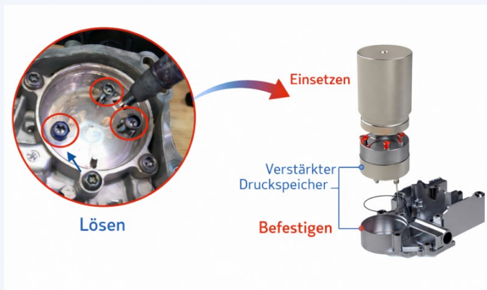
Bild 1: Die 3 Torx-Schrauben lösen → Hülse befestigen → neuen Druckspeicher einsetzen
