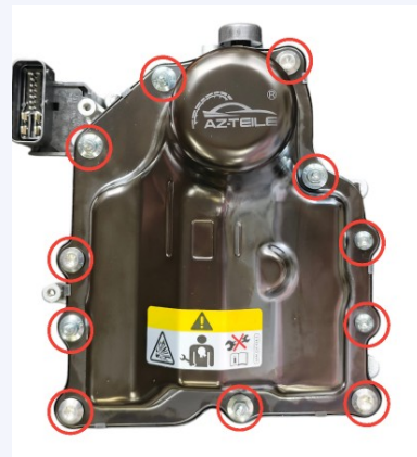
Bild 2: Öl-Deckel – nur die rot markierten Schrauben lösen
