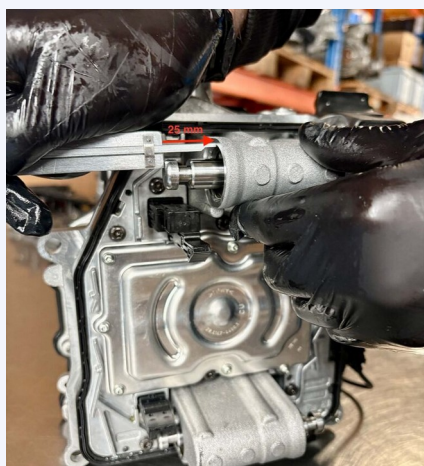
Bild 4: Abstandshalter eindrücken – Stößelmaß 25 mm stellt sich automatisch ein
